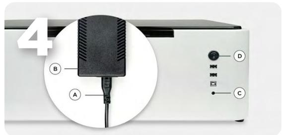
Branchez le câble d'alimentation (A) et l'adaptateur secteur (B). Branchez les deux extrémités de l'adaptateur secteur sur la prise d'alimentation (C) à l'arrière de la machine et insérez la fiche dans la prise. Activez l'interrupteur principal (D) situé à l'arrière de la machine pour allumer la machine.
