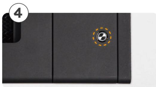
Mettez la machine sous tension en appuyant sur le bouton d'alimentation. Le premier démarrage peut prendre jusqu'à deux minutes.
