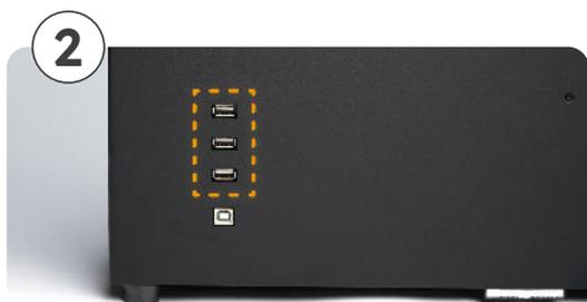
Insérez le dongle WiFi sur le côté droit de l'appareil.
