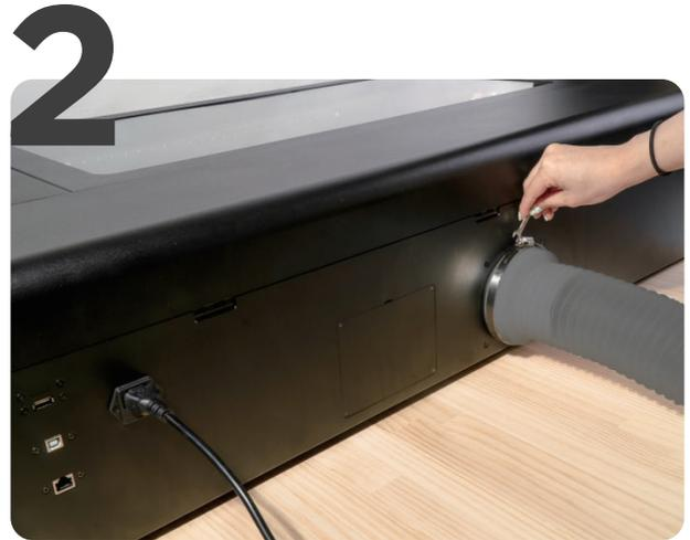
Placez le collier de serrage sur la plus petite extrémité du tuyau de ventilation et enflez-le jusqu'à la plus grande extrémité. Placez l'extrémité la plus grande du tuyau de ventilation dans l'orifice d'échappement. Serrez le collier de serrage à l'aide de la clé à double tête fournie jusqu'à ce que le tuyau de ventilation soit bien fixé.
