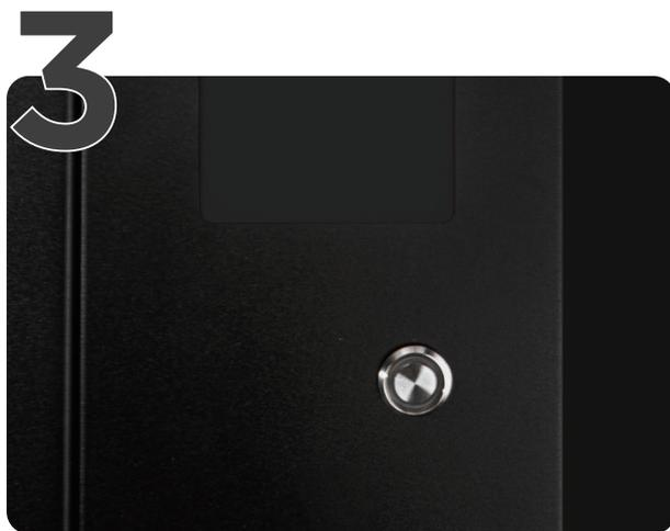
Mettez la machine sous tension en appuyant sur le bouton d'alimentation. Le premier démarrage peut prendre jusqu'à deux minutes.
