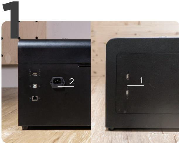
Insérez les deux extrémités du cordon d'alimentation à l'arrière de l'appareil (2) et dans la prise de courant. Insérez le dongle WiFi sur le côté droit de l'appareil (1).
