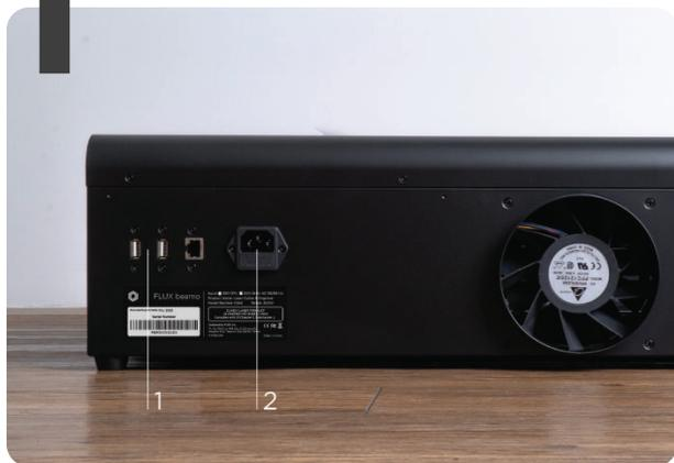
Branchez le cordon d'alimentation à l'arrière de la machine et dans la prise de courant (2). Insérez le dongle WiFi dans (1).
