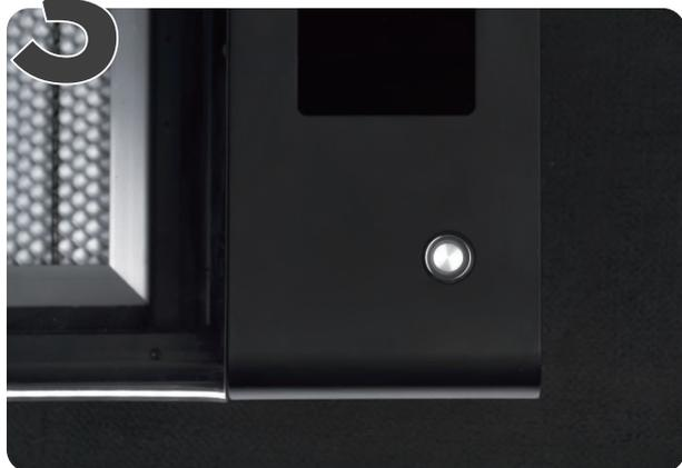
Mettez la machine sous tension en appuyant sur le bouton d'alimentation. Le premier démarrage peut prendre jusqu'à deux minutes.
