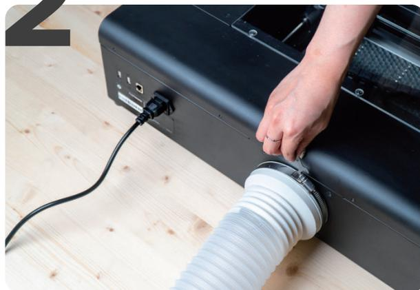
Placez le collier de serrage sur la plus petite extrémité du tuyau de ventilation et enflez-le jusqu'à la plus grande extrémité. Placez l'extrémité la plus grande du tuyau de ventilation dans l'orifice d'échappement. Serrez le collier de serrage à l'aide de la clé à double tête fournie jusqu'à ce que le tuyau de ventilation soit bien fixé.
